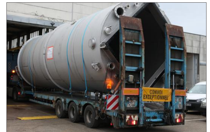
La pièce transportée pèse 11 tonnes et mesure 12 mètres de long et 3,20 mètres de diamètre.
