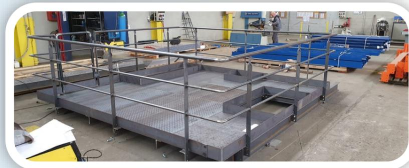
Réalisation (d'une passerelle d'accès de maintenance) pour l'industrie chimique. L'ensemble de l'étude a été effectué en interne : nous avons conçu le modèle 3D, effectué la mise en plan 2D et réalisé les calculs de vérification des connexions, des sections et des poutres suivant la norme Eurocodes. La passerelle a été fabriquée dans notre atelier puis installée sur site par notre équipe.
